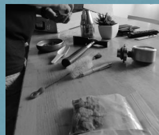
CM-Messung eines Restaurants in Rendsburg
